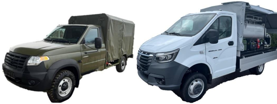
Рисунок 4.21 – Автотопливозаправщики малой вместимости АТЗ-1, 5 (слева) и АТЗ-2 (справа)
