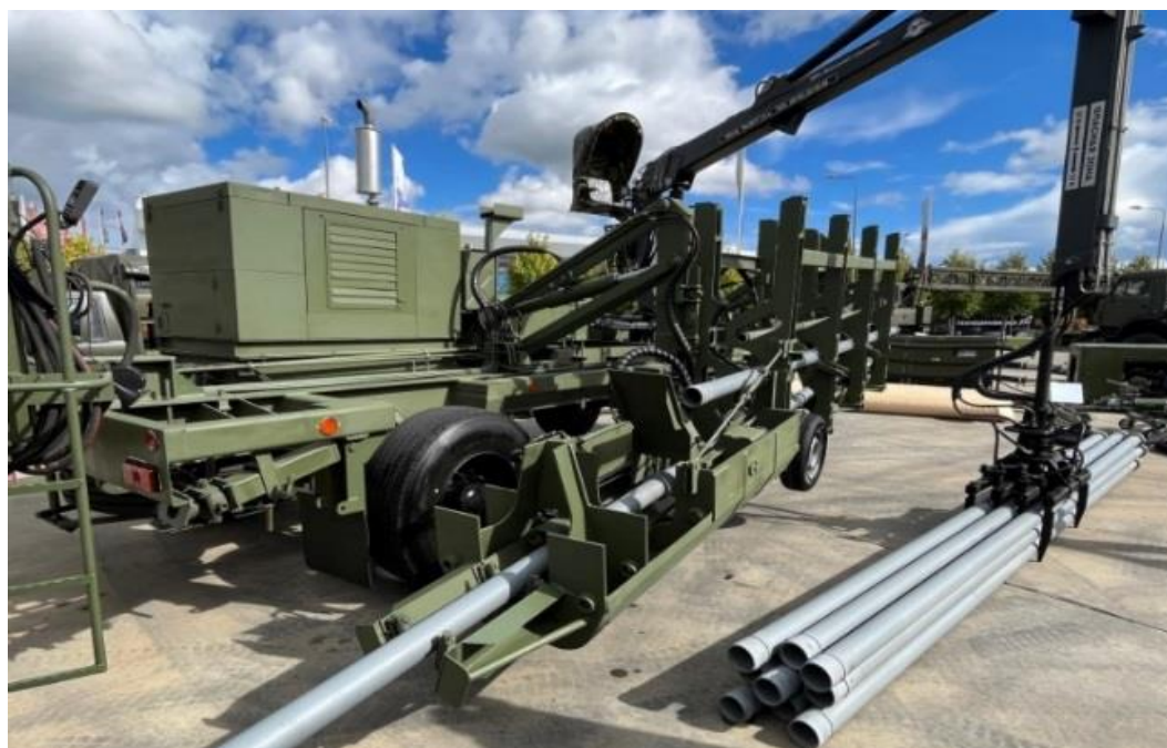
Рисунок 4.2 – Трубомонтажная машина ТММ-100
