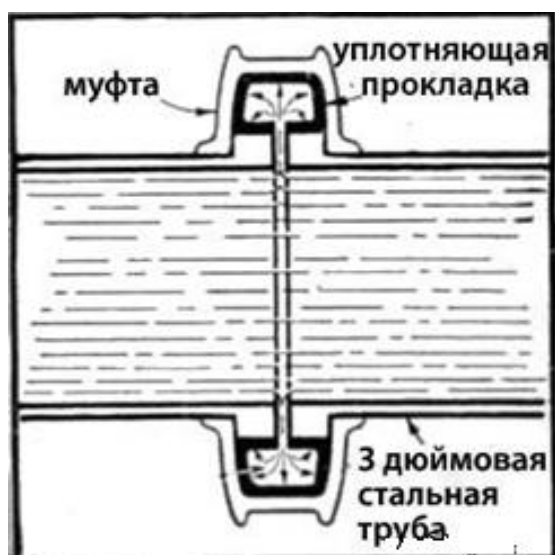
Рисунок 1.4 – Схема соединения труб с помощью соединительных муфт
