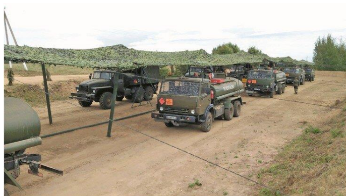
Рисунок 1.22 – Выдача горючего из полевого магистрального трубопровода в автомобильный транспорт
