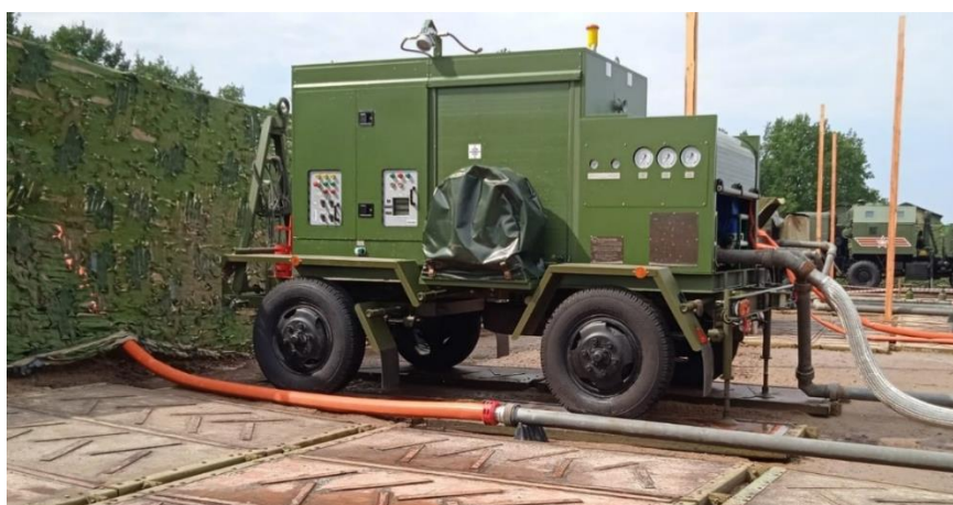
Рисунок 4.5 – Узел учета нефтепродуктов, подключенный к ПМТ
