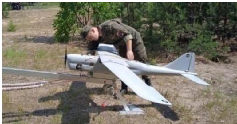
Рисунок 4.4 – Использование БПЛА для разведки трассы трубопровода
