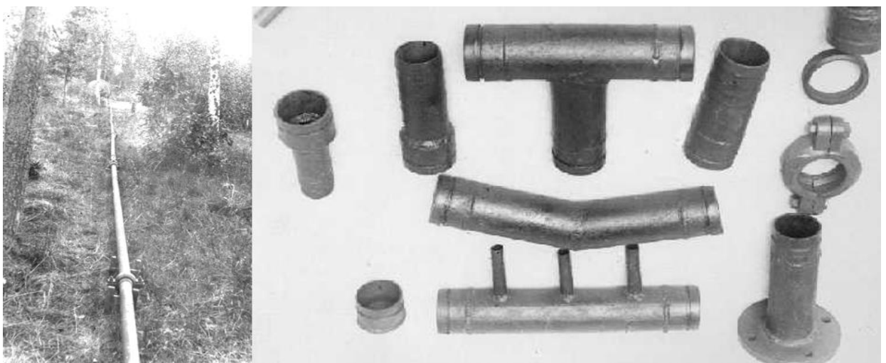
Рисунок 1.1 – Первый отечественный сборно-разборный трубопровод военного назначения (полевой коллектор)
