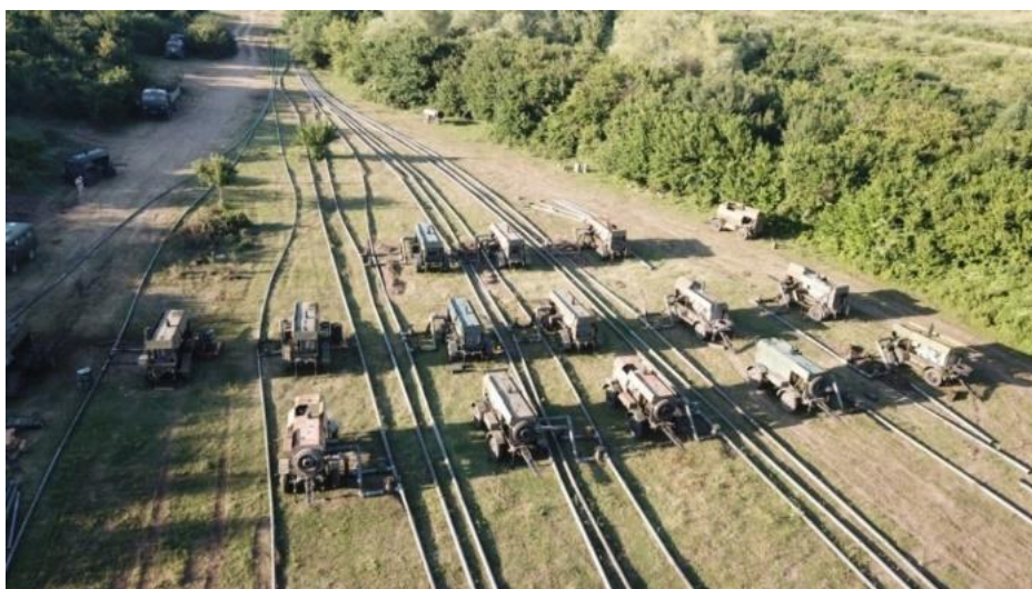
Рисунок 1.25 – Насосная станция на трассе трубопровода
