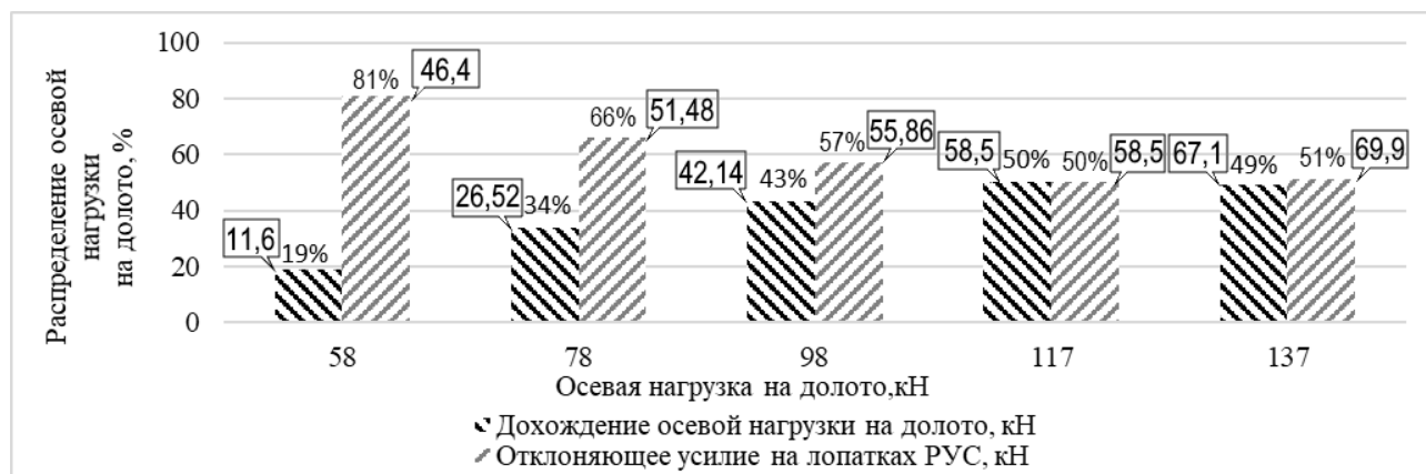
Рисунок 4 – Характер распределения осевой нагрузки на долото на участке ствола скважины с зенитным углом равным 90^\circ
