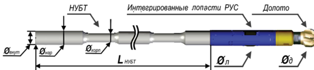
Рисунок 2.15 – Общий вид компоновки РУС с применением НУБТ
