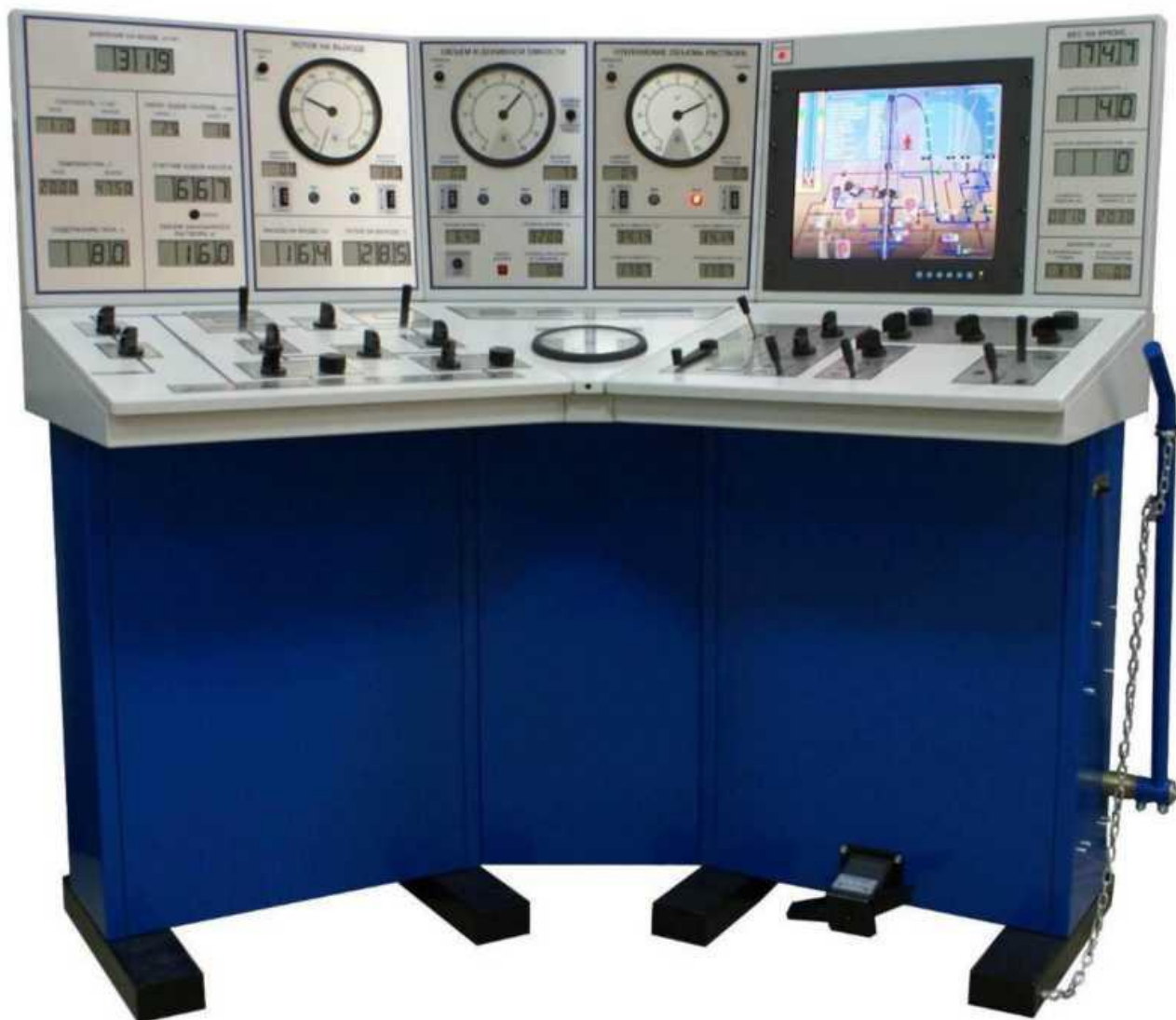
Рисунок 1.12 – Тренажер-имитатор бурения АМТ-231
