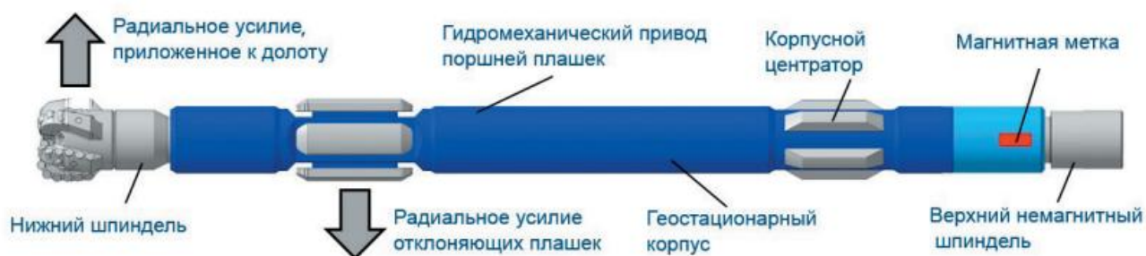
Рисунок 1.9 – Общий вид РУС-ГМ компании «Буринтех»
