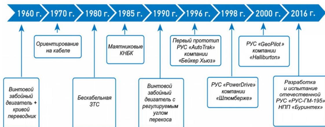
Рисунок 1.7 – Становление технических средств для ННБ
