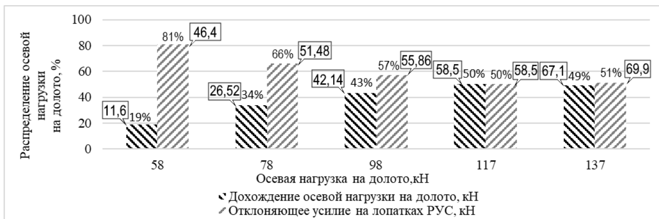
Рисунок 2.25 – Характер распределения осевой нагрузки на долото участка скважины с зенитным углом равным 90°
