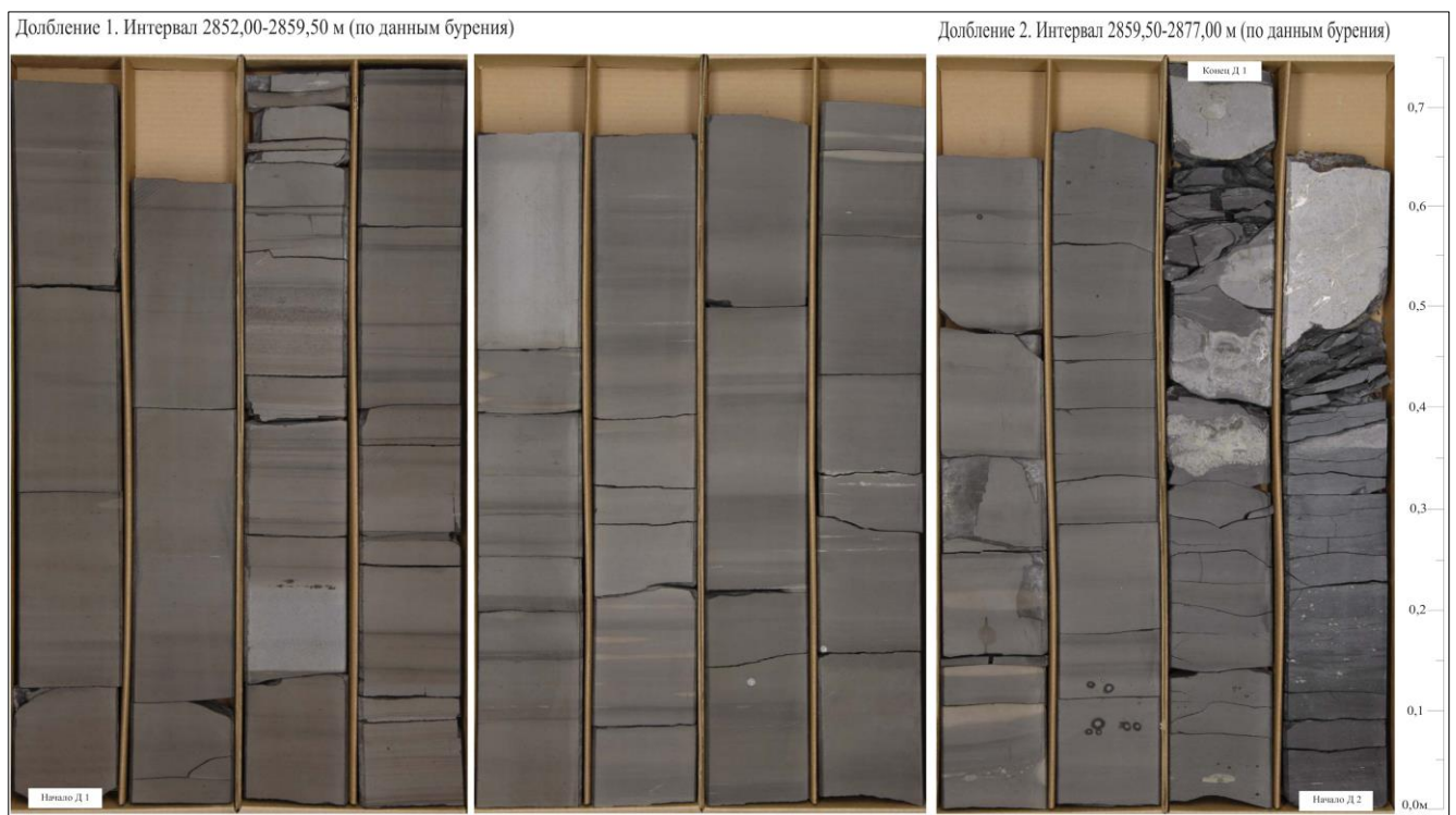
Рисунок 1.4 – Фотографии керна по скважине Северо-Ватъеганского месторождения (по материалам ООО «Лукойл-Западная Сибирь»)
