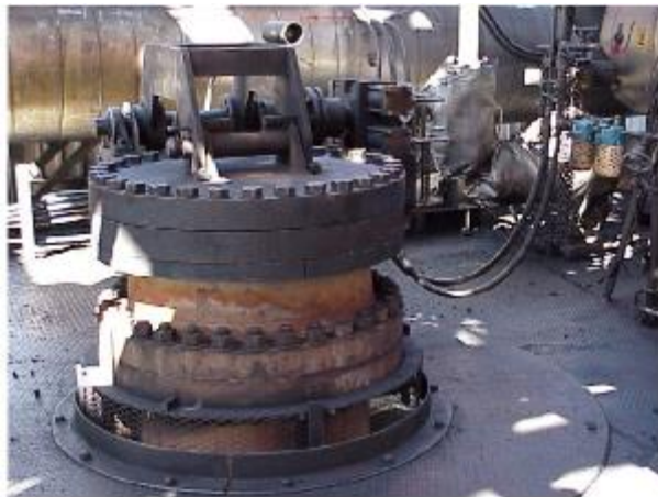
Рисунок 1.17 – Полуавтоматическое устройство открытие верхней крышки [131]
