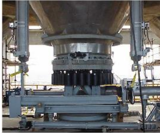
Рисунок 1.16 – Автоматическое устройство открытие нижней крышки [131]
