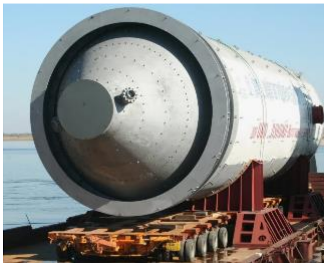
Рисунок 3.18 – Коксовая камера ООО «Лукойл-Волгограднефтепереработка» с двухсторонним боковым вводом сырья [166]
