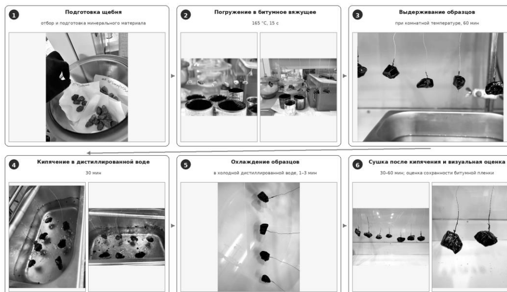
Рисунок 1. Последовательность проведения испытаний адгезионных свойств битумного вяжущего к поверхности щебня.
